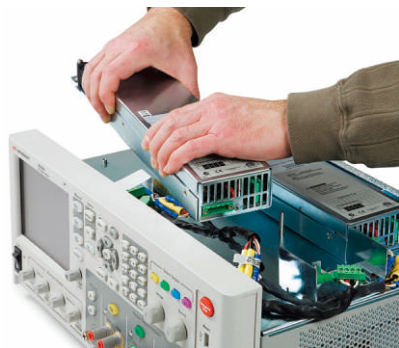
圖 2. 直流電源模組可以很容易地安裝到 N6705 直流電源分析儀主機中。
