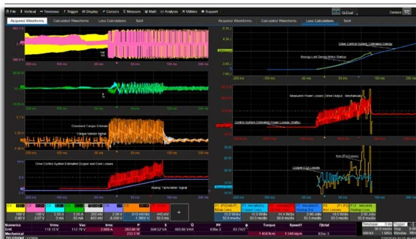
将测量的损耗与驱动控制系统的估计损耗进行比较，并进行进一步的计算，将测量的损耗分离为磁（铁）损耗和负载（铜）损耗
