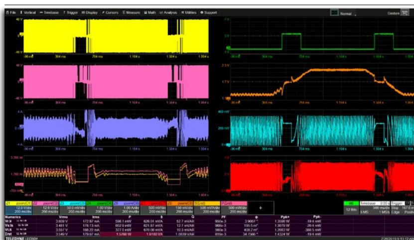
将驱动控制和反馈信号与驱动输出电压和电流以及计算出的功率波形进行比较，以了解电机反转是否正确执行
