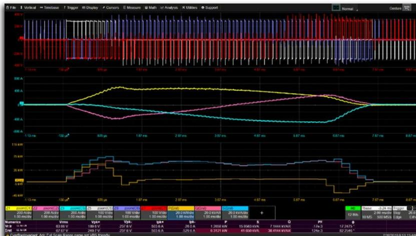
可以通过测量和显示功率器件开关切换时的功率的每周期波形来确定通过命令操作转子变化时的运行
