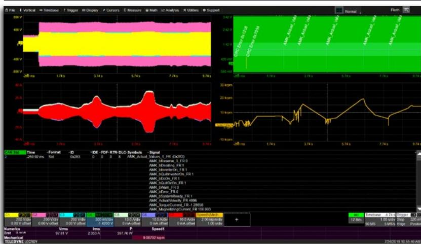
速度数据是从数字CAN编码串行数据中提取的，并绘制为模拟速度每周期波形，就好像直接测试信号一样
