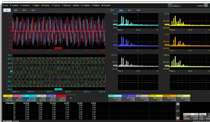
计算任意采集时间波形的谐波，并将它们转化成频谱的方式显示，也可以显示总谐波失真或总谐波失真的每周期波形。
