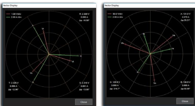
可以同时显示三相电力系统的两个矢量视图，并将它们与采集的电压、电流和其他波形相关联，并计算每周期波形
